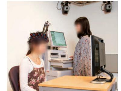
生体に安全な近赤外光を用いて血液量の変化を測定し、脳機能を「視覚化」する装置です。
