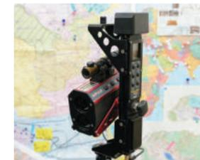
赤外線レーザーを照射し、対象物までの角度と距離を測定する機器。遺跡の調査などに使用します。
